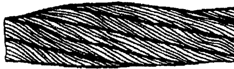
Рисунок 13. Местное увеличение диаметра каната
