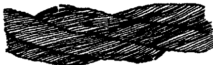
Рисунок 1. Обрывы и смещения проволок каната крестовой свивки
